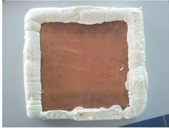
Figure 7 : Brique entourée de mousse de polyuréthane
